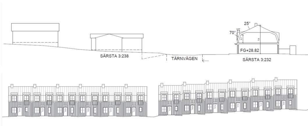
Figur 11; Idéskiss: Sektion och elevation som visar ny bebyggelse mednockhöjd 7,6 meter och mansardtak längs Tärnvägen (Gisselberg Arkitekter, 2025-11-18)
